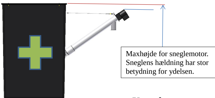
Korrekt monteret snegl.
